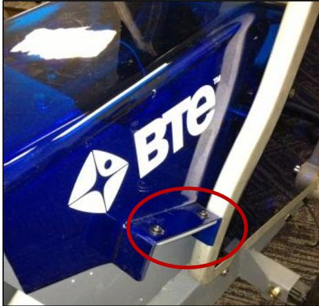
Abb. 13 – Konsolenrahmenschrauben
