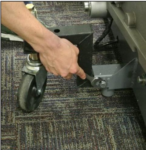
Abb. 3 – Rohrschraube abschrauben
