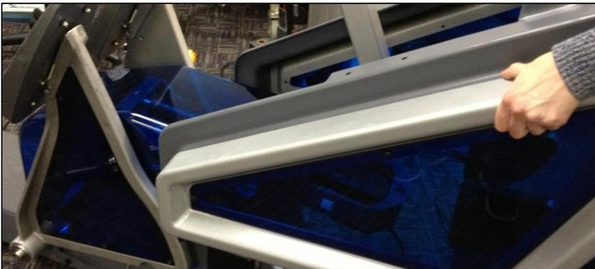
*Abb. 28 – Konsole vom Rahmen heben*
