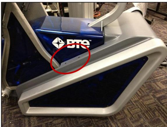
Abb. 18 – Konsolenschraubenbefestigung
