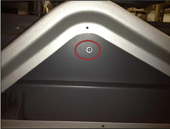
*Abb. 11 – Befestigen der Seitengehäuse*
