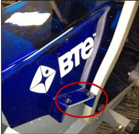
Abb. 13 – Konsolenrahmenschrauben
