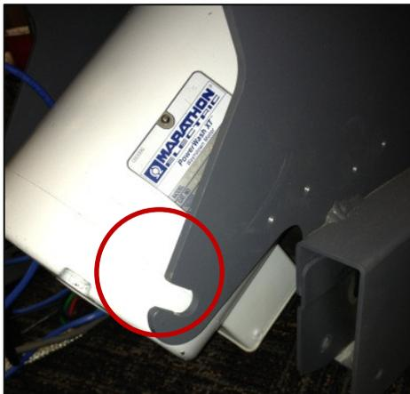
Abb. 14 – Stahlbefestigungshaken
