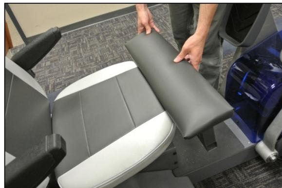
Abb. 10 – Verstellung der Kniewunterlage
