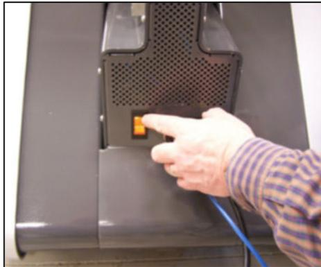
Abb. 23 – Netzschalter
