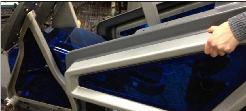
*Abb. 28 – Konsole vom Rahmen heben*
